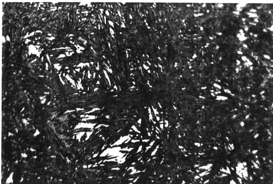
Figura 22: Micrografia do aço DIN 100Cr6 temperado e revenido. Amostra C5 Austenitização: 1010°C por 60 minutos. Ataque Nital. 500X.
